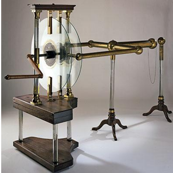
Wrijvingselectriseermachine (ongeveer manshoog)
