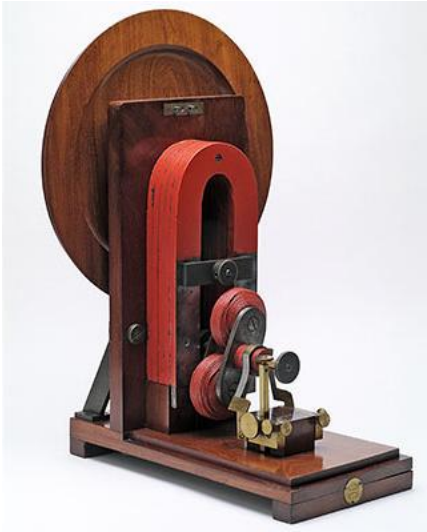
Elektromagnetische generator volgens Clarke
